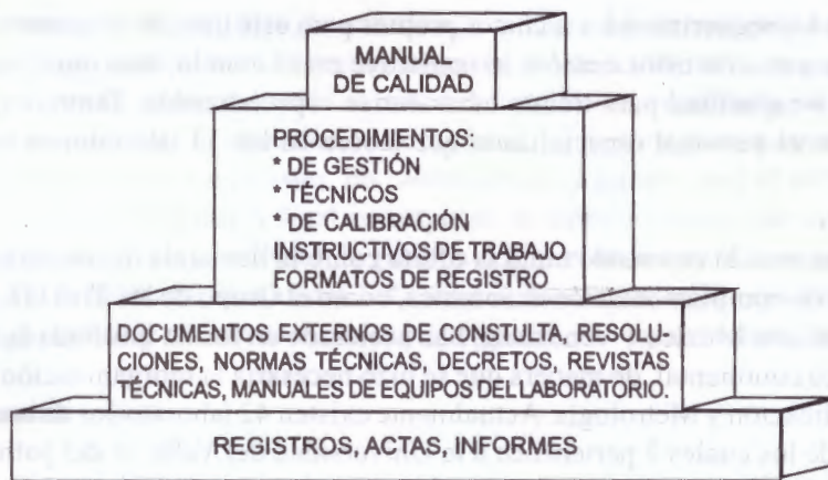
Figura 1. Estructura de la documentación del laboratorio
